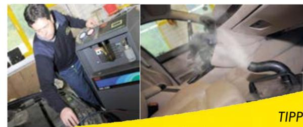
**TIPP:** Ultraschall oder Ozongenerator. Das gesamte Heiz- und Lüftungssystem sowie der gesamte Fahrzeug-Innenraum werden mithilfe von kaltem und trockenem Rauch, der durch Ultraschall erzeugt wird, desinfiziert. Gleichzeitig werden Pollen, Gerüche, Mikroben, Pilze und Bakterien abgetötet.
