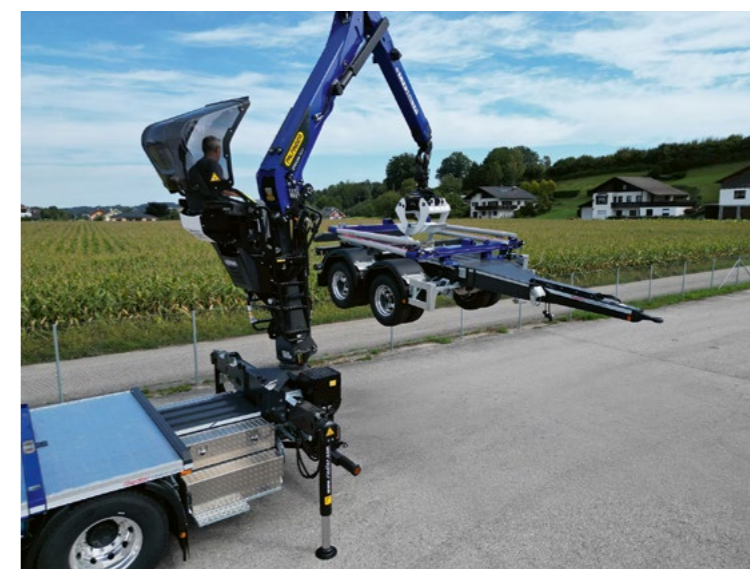
Der Anhänger wird auf dem Alu-Plateau abgestellt und die Zugöse wird durch einen Bolzen in der Stirnwand gehalten. Der Tandem-Rungenanhänger wird mit dem Holzladekran an einem hochklappbaren Kranhebebühnen gepackt und aufgeladen
