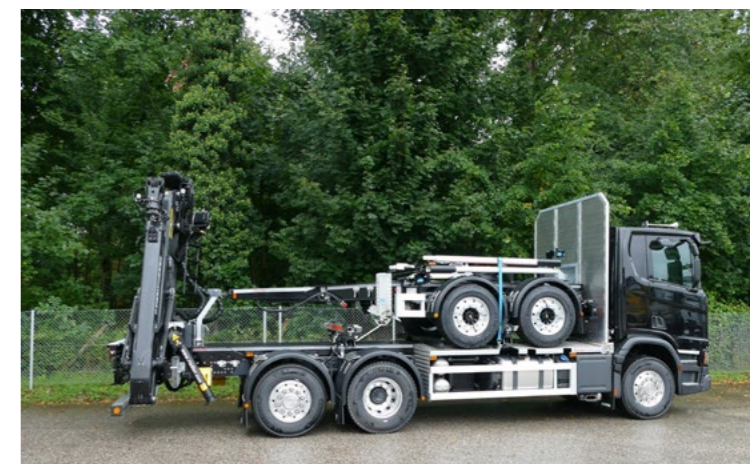
Der Anhänger wird auf dem Alu-Plateau abgestellt und die Zugöse wird durch einen Bolzen in der Stirnwand gehalten. Der Tandem-Rungenanhänger wird mit dem Holzladekran an einem hochklappbaren Kranhebebühnen gepackt und aufgeladen
