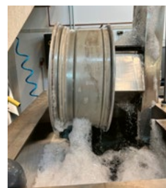
Jede Felge wird zu Beginn einer Reparatur oder eines Veredelungsprozesses bei Wheelmasters gründlichst mit einer hochmodernen Ultraschall-Anlage gereinigt.
