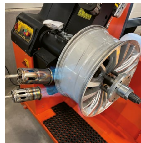
Die Felge wird vorsichtig erhitzt und in Form gebracht.
